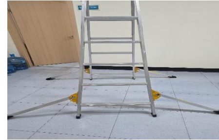
[사다리 아웃 트리거 설치]
